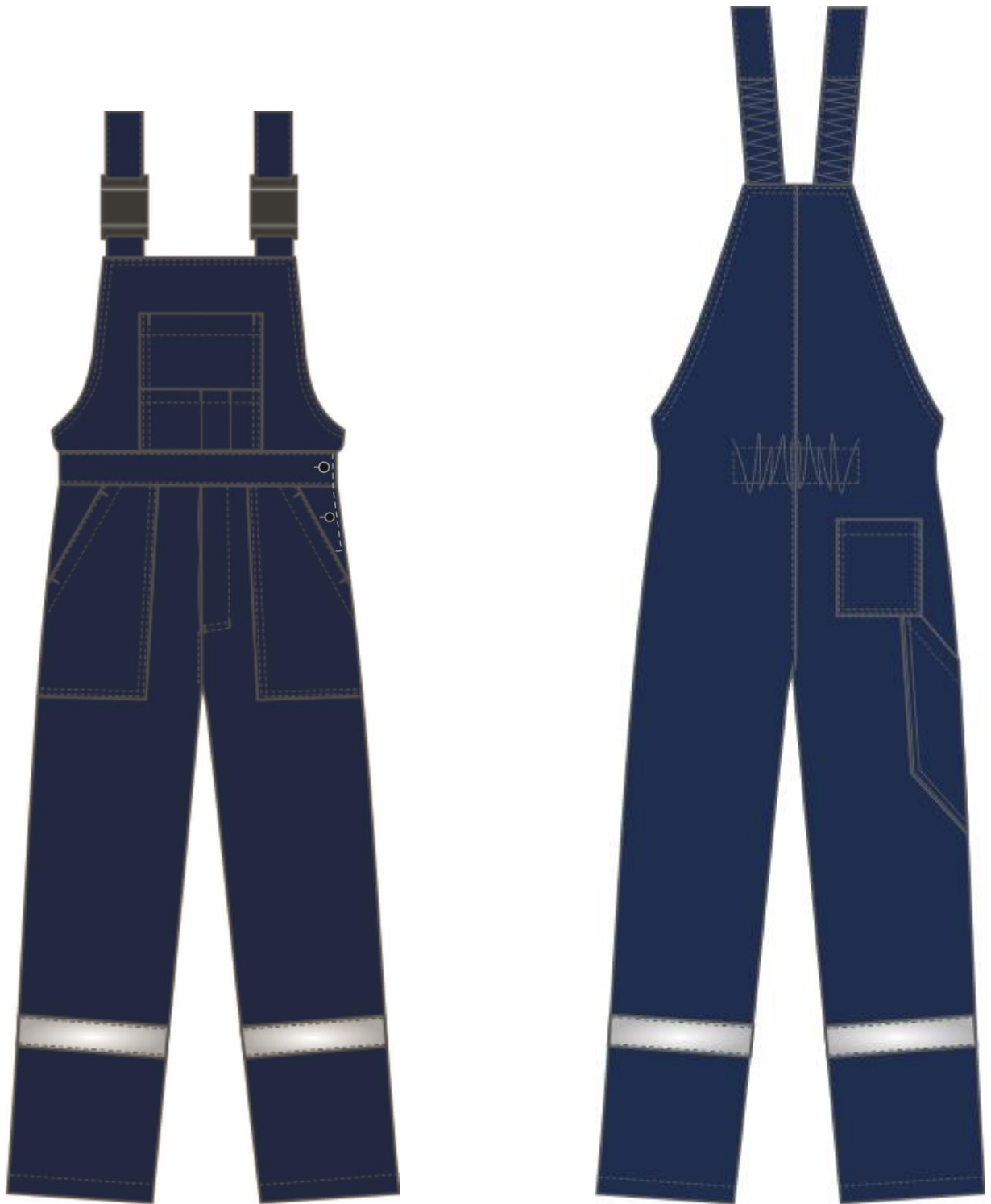
Рис. 3. Эскиз Костюм Галакт МВО (тк.Смесовая 50/50,220) п/к, т.синий/серый, полукомбинезон. Вид спереди и сзади.
