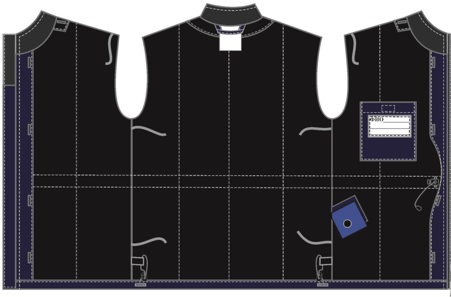
Рис. 2. Эскиз Костюм зимний Эксперт-Антистат МВО (тк.Смесовая,245) п/к, т.синий/васильковый. Куртка, вид с изнанки.
